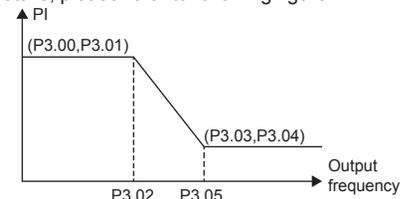
**Figure 6.5PI parameter diagram.**
